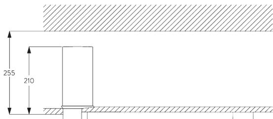
レール SG 10850 をクランプ SG 3004 を使用して天井面へ設置の場合
