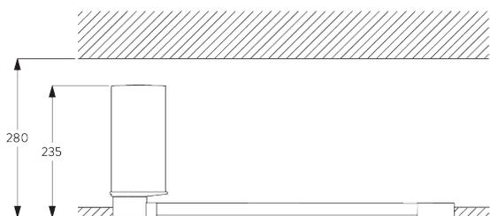
レール SG 10850 をリセスレール SG 10862 を使用して天井面へ埋め込んで設置の場合
